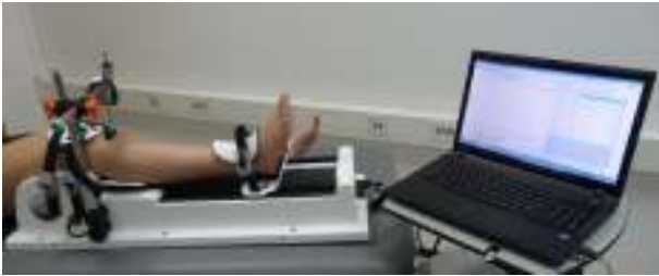
Slika 1: Postavitev preiskovane noge na kolenski artrometer GNRB
